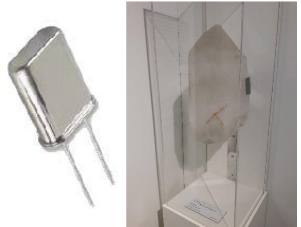
Typische quartz crystal in behuizing, en hoe je deze in de natuur kan terugvinden.
